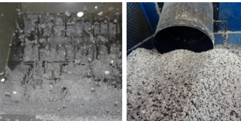
Mleti EPS: za pripravo lahkih betonov ali nadaljnjo predelavo
