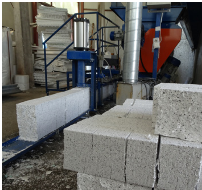
Stiskanje mletega EPS za bolj ekonomičen transport
